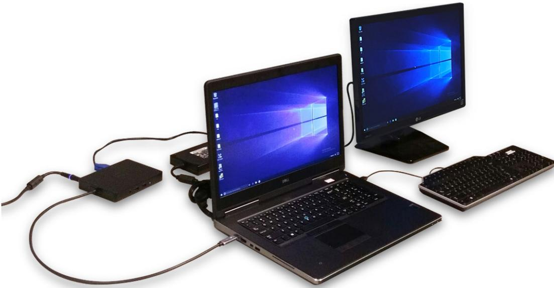
**ⓘ ANMERKUNG:** Computer, die eine Eingangsleistung von mehr als 130 W benötigen, müssen zum Aufladen und für einen Betrieb bei voller Leistung auch an einen eigenen Netzadapter angeschlossen sein.
