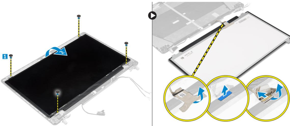
4 So entfernen Sie den Bildschirm bei Systemen mit Touch-Funktion:
